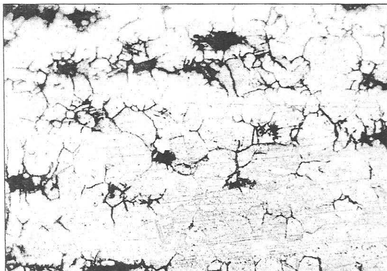
Figura 4. Imagine de microscopie optică (x200) a unei probe din oglinda romană nr. 2; atacată cu clorură ferică; structură dendritică de turnare și compuși globulari de \text{Cu}_2\text{O} .
